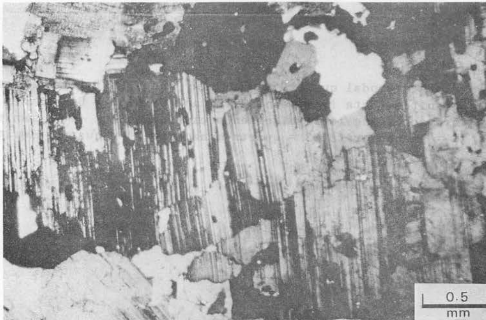
Fig. 3b. Annealed dislocated plagioclase.
