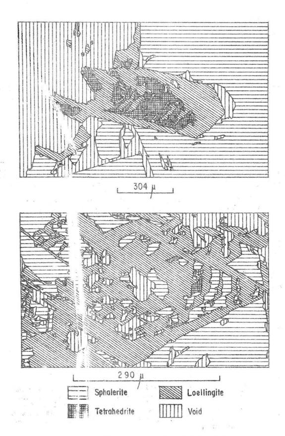
FIGURE I (TRACED FROM PHOTOMICROGRAPHS)
